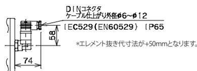
E,D: 電気接点式インジケータ
